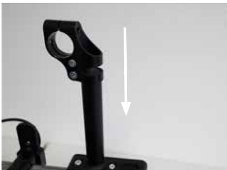
Die Klemme wieder mit der Ausrichtung nach Vorne auf den Hinterachsrahmen aufstecken
