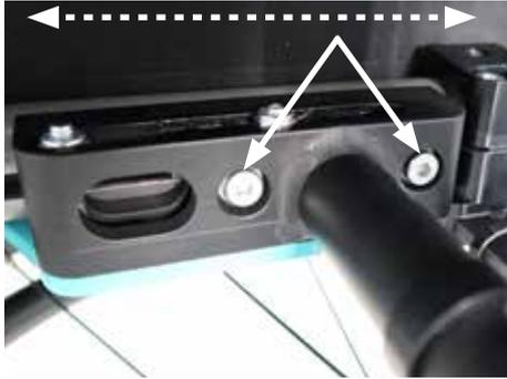
Nach Lösen der Verschraubung von Hinterachsrahmen und Klemmstrebe im Rahmenrohr, kann die gesamte Hinterachsaufnahme verschoben werden
