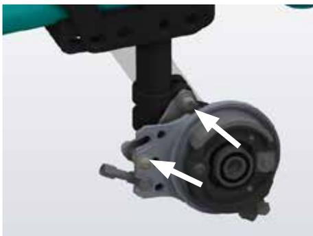
Überprüfung der Verschraubungen:
