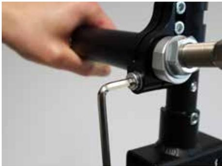
Schraubverbindung zur Achsaufnahme lösen und Schrauben komplett entfernen. Im Anschluss die Sturzadapter entfernen und die Achse aus der Aufnahme ziehen.
