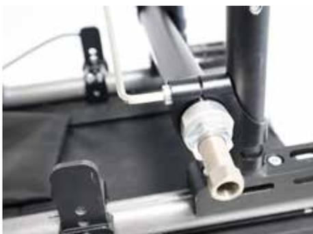
Die Achse einstecken und die Sturzadapter wieder fest verschrauben. Die genaue Ausrichtung Richtung Boden ist hierbei unbedingt mit einer Libelle/Wasserwaage zu überprüfen
