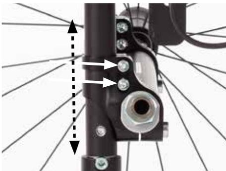
Für das Verschieben der Hinterradachse müssen entsprechende Verschraubungen gelöst werden. Anschließend kann die Achse entlang der Achsaufnahmen verschoben werden.
