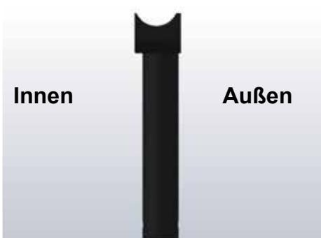
**Wichtig, egal ob die Ausrichtung nach Vorn oder Hinten erfolgt, der Hinterachsrahmen muss immer wie abgebildet mit der schmalen Seite nach Außen angebracht sein!**
