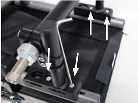
Die Verschraubungen von Hinterachsaufnahme zum Oberzug des Rahmens muss nun auf beiden Seiten gelöst und entfernt werden
