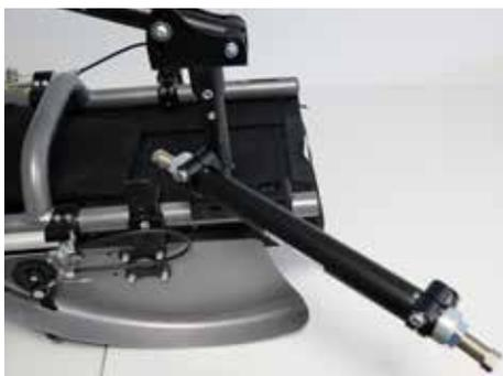
Den Achsrahmen in neuer Ausrichtung wieder aufsetzen und die Achse um  $180^\circ$  rotieren
