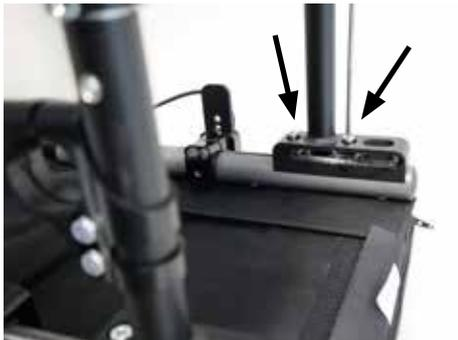
Auf der Gegenseite den Hinterachsrahmen ebenfalls in neuer Position ausrichten und verschrauben.
