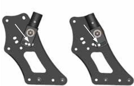
Über die 5 Lochpositionen der Rückenbasis und des Abstandhalters, kann die Feinjustierung innerhalb des 22,5° Verstellbereichs erfolgen, je nachdem wie die Schraube eingesetzt wird.
