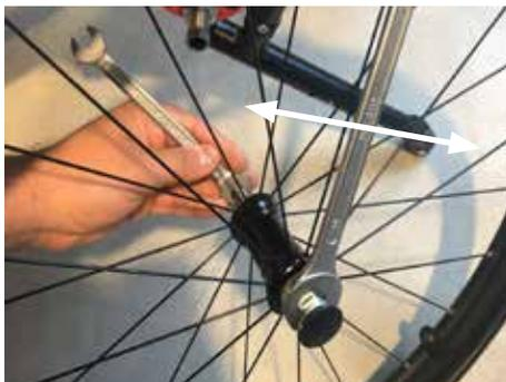
Einstellung der Quick-Release Achse:
