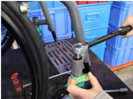
Ist die Achse nun gerade ausgerichtet, kann die obere Verschraubung mit 20 Nm fest angezogen werden.
