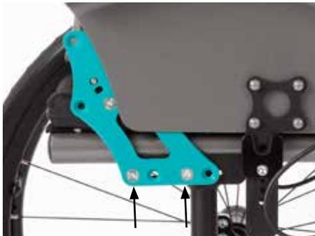
SUPRA 2.0 bietet einen Vertellbereich von 0 - 10 cm. Für die Verstellung müssen die entsprechenden Schraubverbindungen der Rückenbasis zur Hinterachsaufnahme gelöst, in den Langlöchern verschoben oder umgesetzt werden.
