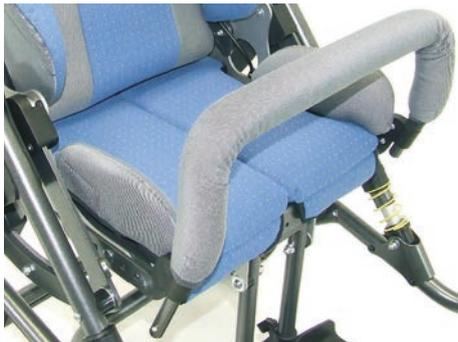
Stellen Sie sich zum Abnehmen des Haltebügels seitlich in Blickrichtung neben die Sitzeinheit. Greifen Sie von oben herab links und rechts an die Enden des Haltebügels. Drücken Sie mit dem Zeigefinger den Stativfederknopf und ziehen Sie den Haltebügel nach oben heraus.
