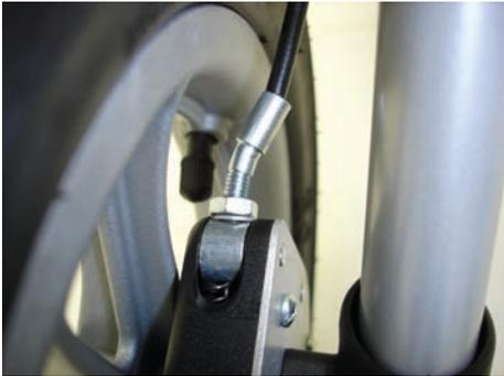
Am Ausgang der Bremsgehäuse sitzen jeweils links und rechts nach innen gekrüpfte Bowdenzugführungen. Diese führen den Bowdenzug innen am Hinterrad vorbei.
