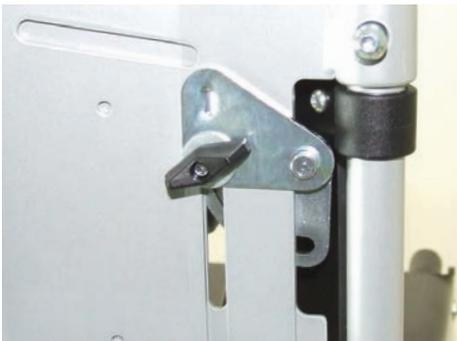
Nach Lösen der Flügelmutter kann die Thoraxpelotte stufenlos in der Höhe verstellt werden und durch Verdrehen von der Horizontalen bis in die Senkrechte eine Breiteneinstellung der Pelotten zueinander vorgenommen werden.
