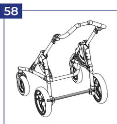
58 Verstärkte Hinterachse
