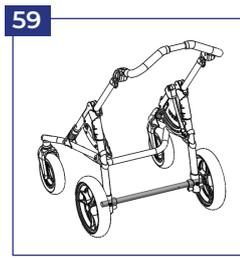
59 Verstärkte Hinterachse
