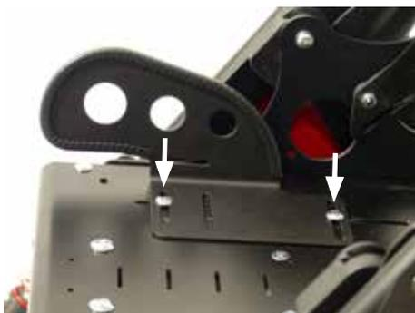
Die Pelotte wird durch eine Schraubverbindung zum Sitzblech gesichert. Durch die Verschiebung in 2 Langlöchern können die gewünschten Sitzbreiten erreicht werden. Zusätzlich kann die Tiefenpositionierung angepasst werden.
