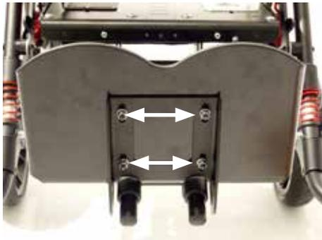
Nach Lösen der vier markierten Verschraubungen am Fußbretthalter kann das Fußbrett in der Tiefe verstellbar werden.
