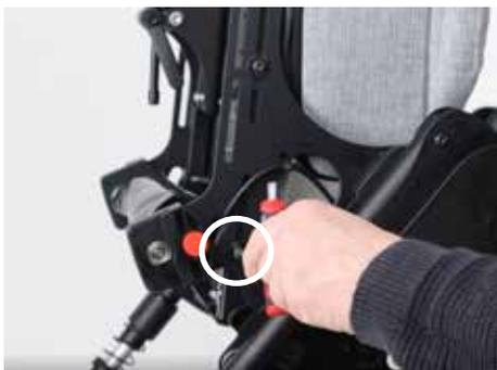
Anschließend wird die Sitzeinheit entriegelt und man kann die hinteren Schrauben lösen.
