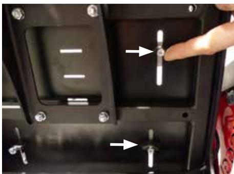
Durch Flügelmutterschrauben auf der Unterseite des Sitzbleches wird die Verbindung gesichert. Eine zusätzlich angebrachte Mutter dient als Verlierschutz und sollte stets montiert sein.
