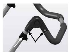
Überprüfung der Verschraubungen:
