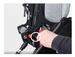
Anschließend wird die Sitzeinheit entriegelt und man kann die hinteren Schrauben lösen.
