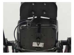
Bei Größe mini wird die Teleskopierung über eine Rändelmutter ausgelöst.
