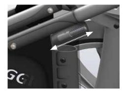
Rasten des Schiebebügels im aufgefaltetem Zustand, Bolzen muss sich beim Zusammenfalten aus der Verriegelung lösen und beim Auffalten im Hinterrahmengelenk arretieren.
