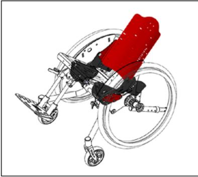
CLEO mit 45° Sitzkantellung, mit winkelverstellbarem & abklappbaren Rücken
